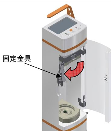
①正面のカバーを開け、パチン錠を外して固定金具を手前に開きます。
