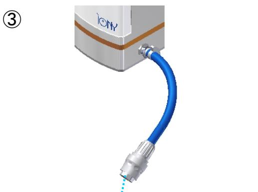
③IN側ホースのホースコネクタ側を装置本体より低い位置にして装置内の水を排水します。
