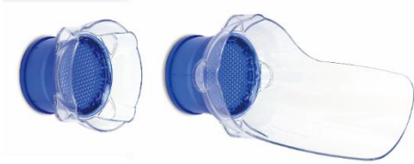
図 31 フードの形状例. 右のような形状は補綴系の処置に向いていると思われるが、術野に近づけることが難しい. そのため, エアロゾル等の吸引を目的とする場合, 左のようなフラットな形状のほうが好ましいと考えている.
