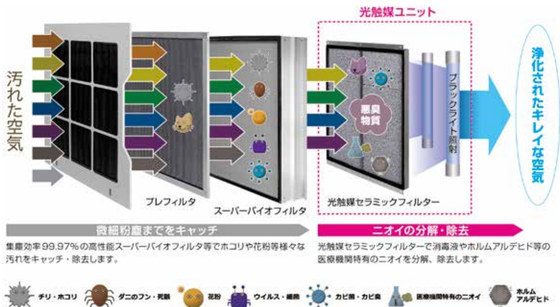
図10 メディカルライトエアの浄化メカニズム（東京技研資料より引用）
