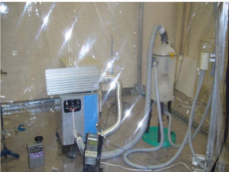
簡易クリーンルーム ◆空気清浄度: <100 particles, 0.5 μ
